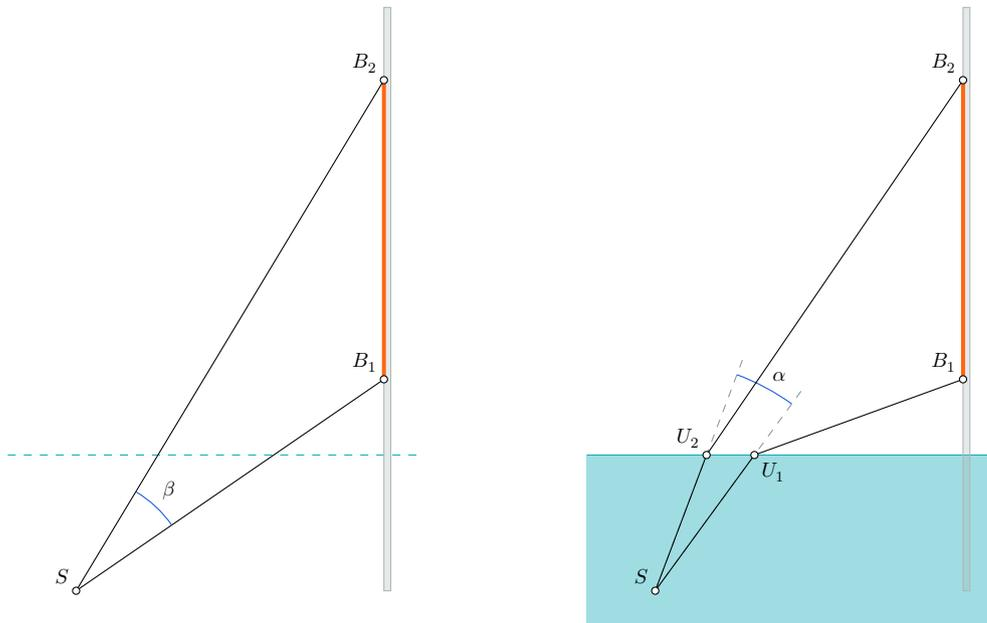
Figure 1: Les deux angles, sans et avec réfraction, déterminés par le diamètre vertical  $[B_1B_2]$  et le point  $S$ .
