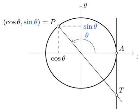
Figure 2: Le cercle trigonométrique et  $\theta$ , la mesure principale de l'angle orienté déterminé par  $P$ . Les coordonnées cartésiennes de  $P$  sont alors  $(\cos \theta, \sin \theta)$ . Si  $T$  est le point d'intersection de la droite  $(OP)$  avec la *droite tangente* au cercle trigonométrique en  $A$ , alors les coordonnées de  $T$  sont  $(1, \tan \theta)$ .
