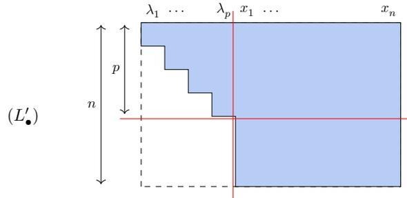
Figure 6: Le système  $(L_\bullet)$  est transformé en  $(L'_\bullet)$  par la méthode de Gauss qui utilise les inconnues  $\lambda_k$  comme pivot. Dans cette représentation graphique,  $n = 7$  et  $p = 4$ . Les  $n - p$  équations en bas à droite représentent un système d'équations pour le sous-espace  $F$  initial.
