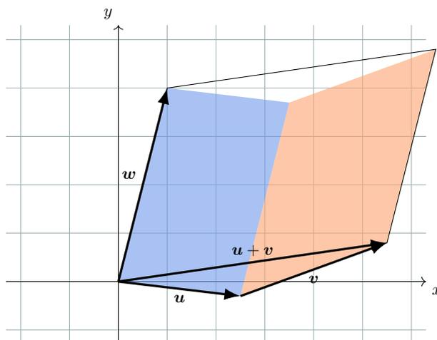
Figure 8: L'additivité du déterminant en chaque variable : l'aire du parallélogramme engendré par les vecteurs  $\mathbf{u} + \mathbf{v}$  et  $\mathbf{w}$  et égale à la somme des aires des parallélogrammes engendrés par  $\mathbf{u}$  et  $\mathbf{w}$  et, respectivement, par  $\mathbf{v}$  et  $\mathbf{w}$ .
