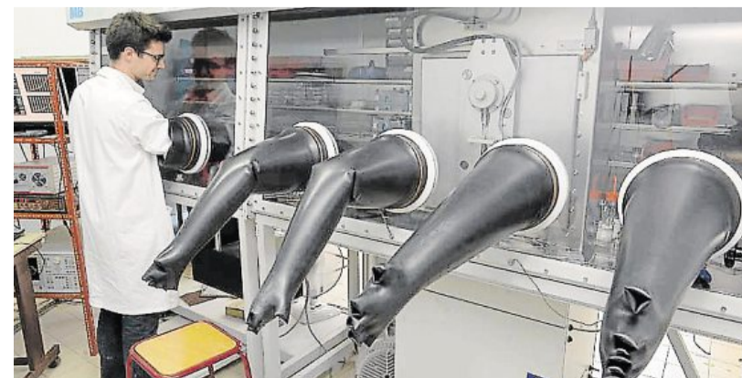
Dans cet appareil du labo de chimie, David enfle de drôles de gants. À l'intérieur, un simulateur solaire permet de travailler sur les cellules solaires photovoltaïques.
